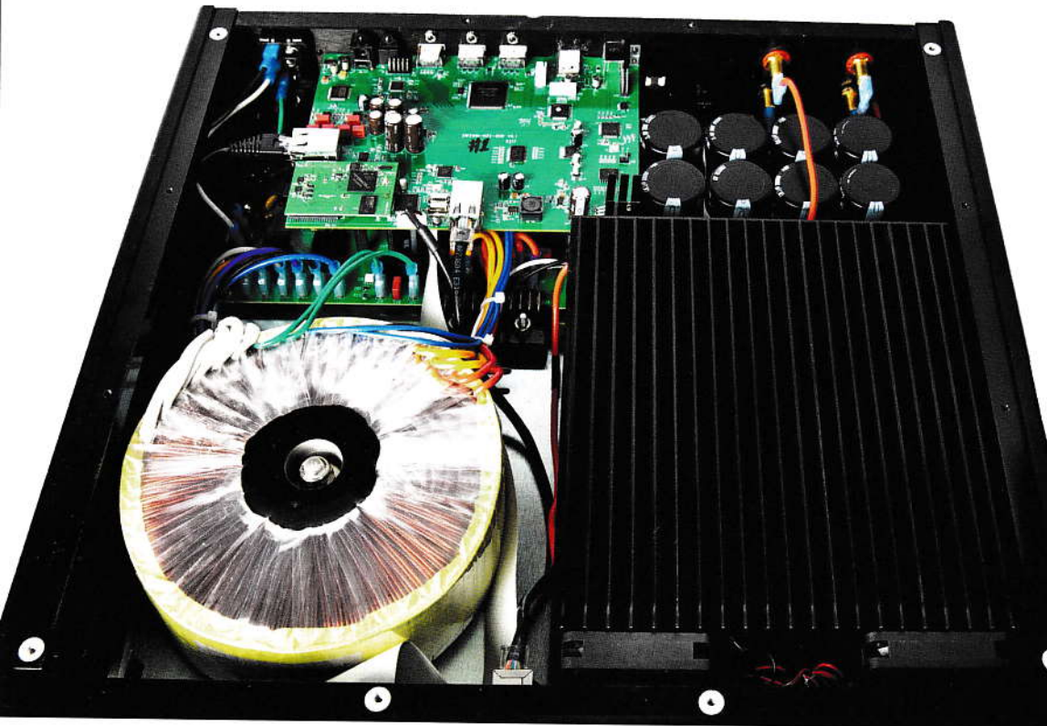
Der mit 770 Watt Nennleistung angegebene Ringkerntrafo (vorn links) dominiert Optik und Gewicht, die Kühlkörpereinheit (rechts) ist nach Kanälen getrennt belegt und bei Bedarf durch zwei Mini-Lüfter unterstützt. Oben rechts die Siebkondensatoren, daneben thront das Digital/Streaming-Board.
